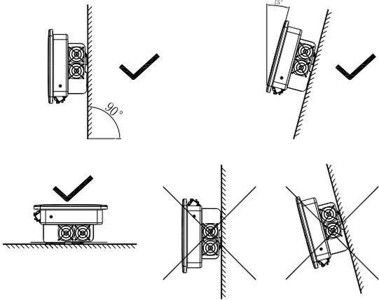
图 4.1 安装示意图
