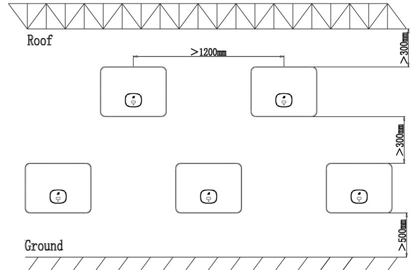
图 4.3 多台逆变器时的安装尺寸
