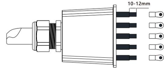
图 5.2 AC输出线压接端子示意
