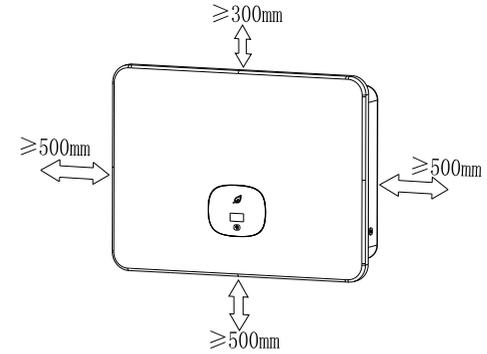
图 4.2 一台逆变器时的安装尺寸
