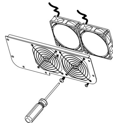
图 11.2 拆风扇示意
