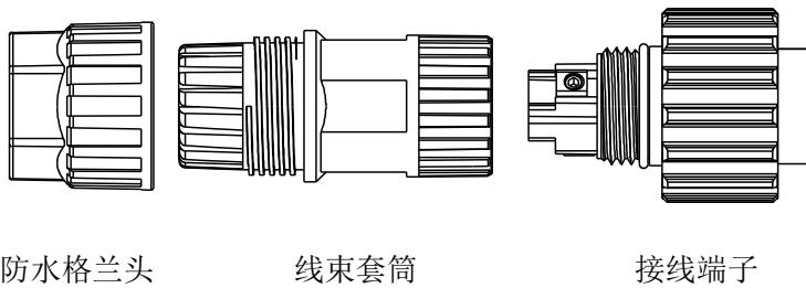
3. 将 L, N, PE 导线剥开 10mm 穿过防水格兰头插进指定的孔位中, 拧紧螺丝, 注意对应线序, 确保线缆连接可靠。
