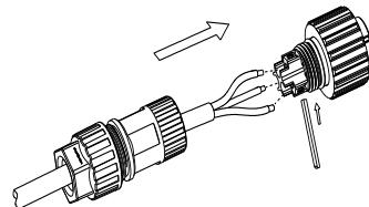
4. 将线束套筒连接接线端子, 然后拧紧锁紧螺母。
