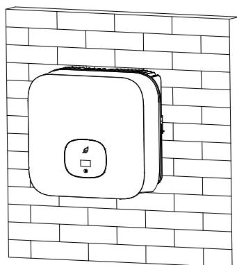
2. 为了保证逆变器能够可靠的固定在墙上，用左侧或者右侧的 M6 安全螺栓把逆变器的侧面固定。
